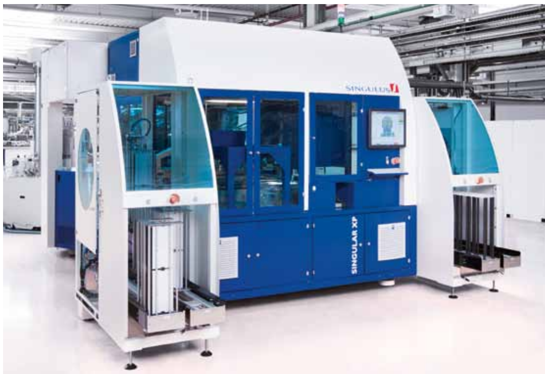
01 SINGULAR XP Vakuum-Beschichtungs- anlage für die Rückseiten- beschichtung bei PERC- Solarzellen
